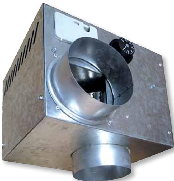
Cajas de ventilación especialmente diseñadas para el aprovechamiento y distribución del calor producido por chimeneas, fabricadas en chapa de acero galvanizado, con aislamiento térmico, termostato regulable integrado (de 0 a 90°C) y motor monofásico 230V-50Hz. Únicamente aptas para vehicular aire limpio que es captado desde la cámara que rodea el conducto de extracción de la chimenea-hogar (el aire no puede contener ceniza).
